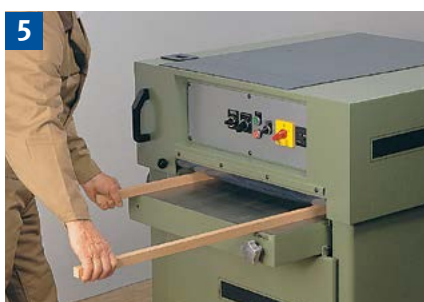
Hobeln schmaler Werkstücke. Bei starren Einzugs- und Druckbalken maximal zwei Werkstücke gleichzeitig bearbeiten.
