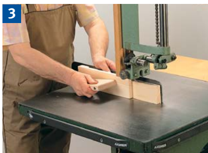
Auftrennen am Anschlag mit Zuführlade.
