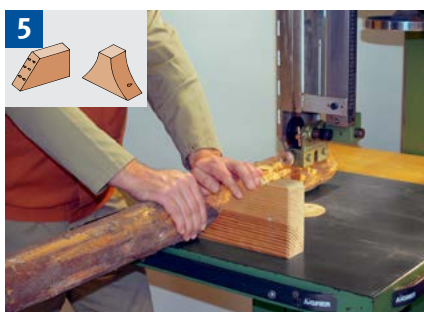
Quersägen von Rundholz mit Keilstütze.
