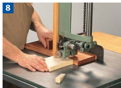
Sägen von Keilen mit Keilschneidlade.
