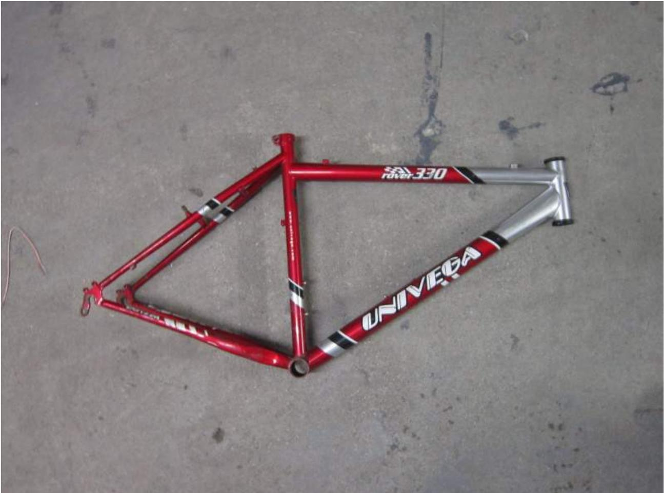
Abbildung 3.4: ungemuffter, geschweißter MTB-Stahlrahmen; Quelle: [1]
