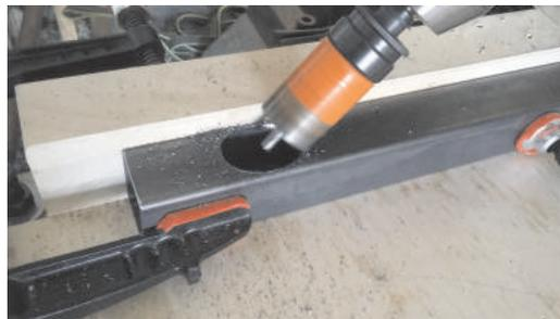
(c) Fertig gebohrter Unterrohrknick
