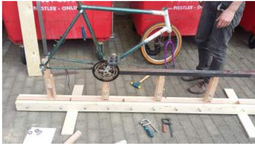
(a) Ausrichten des Fahrradrahmens auf der BikeBench
