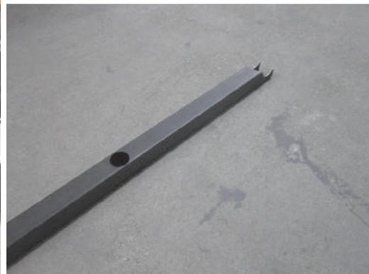
(d) Unterrohr mit Bohrung für das lange Steuerrohr; Quelle: [1]
