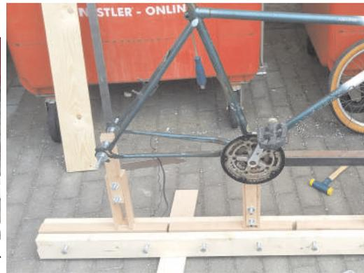
(b) Grobes Ausrichten des Fahrradrahmens auf der BikeBench samt Unterrohr
