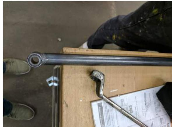
(b) Lager für die Lenkstange (Plastikbuchse anstatt einer Sinterbuchse)
